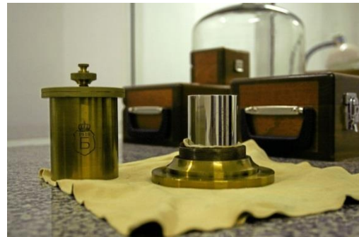
Първият еталон за маса на България, теглилка 1 kg, е утвърден с държавен указ през 1911 г. и се съхранява в БИМ като музееен експонат от 2004 г.
