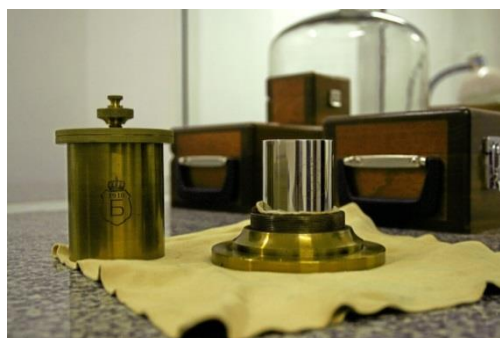
Първият еталон за маса на България, теглилка 1 kg, е утвърден с държавен указ през 1911 г. и се съхранява в БИМ като музеен експонат от 2004 г.
