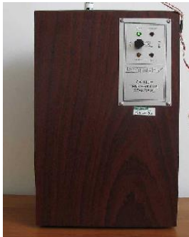
Апарат за реализиране на реперна точка галий
